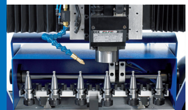
Spindel 2 KW SK 20 mit 6-fach-Magazin, BZT PFX-700 Spindle 2KW SK 20 with 6-times magazine, BZT PFX-700
