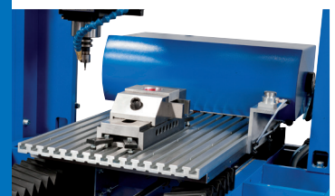
6-fach-Magazin im Gehäuse, BZT PFX 700-1 6-times magazine protected in the housing, BZT PFX 700-1
