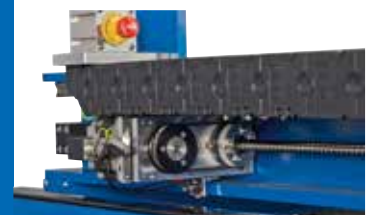
Angetriebene Mutter: links und rechts Driven screw nut: on the left and right
