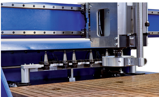
10-fach-Magazin geschützt im Gehäuse, optional Optional 10-times magazine protected in housing
