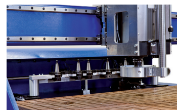
10-fach-Magazin geschützt im Gehäuse, optional 10-times magazine protected in the housing, optionally
