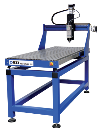
BZT PFE 1500, Portalerhöhung Z 250 mm BZT PFE 1500, Portal heightening Z 250 mm
