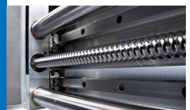
Verstärkte X-Achse mit Bosch-Führungswagen BZT PF 1010-P, BZT PF 1410-P und BZT PF 1610-P Strengthened X-axis guiding carriage with Bosch, BZT PF1010-P, PF 1410-P and PF 1610-P
